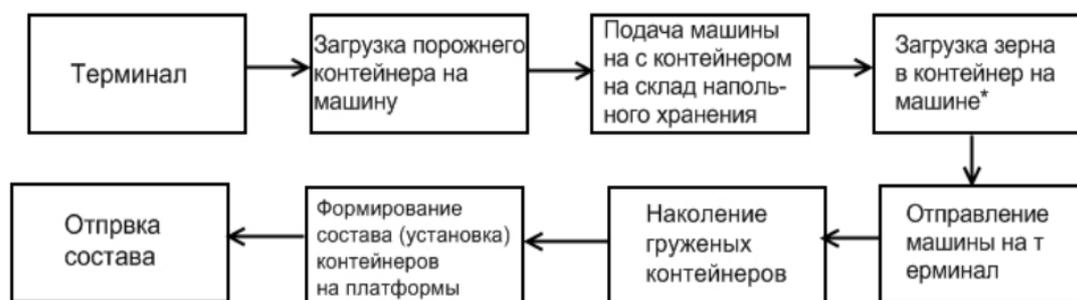
Рисунок 1 – Технология перевозки зерна в контейнерах
