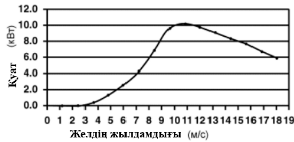
Сурет 5 Жел генераторының қуаты мен жел жылдамдығының графигі
