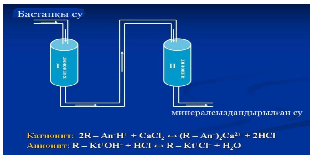
Сурет 3 Суды тұзсыздандырудың ион алмасу схемасы
