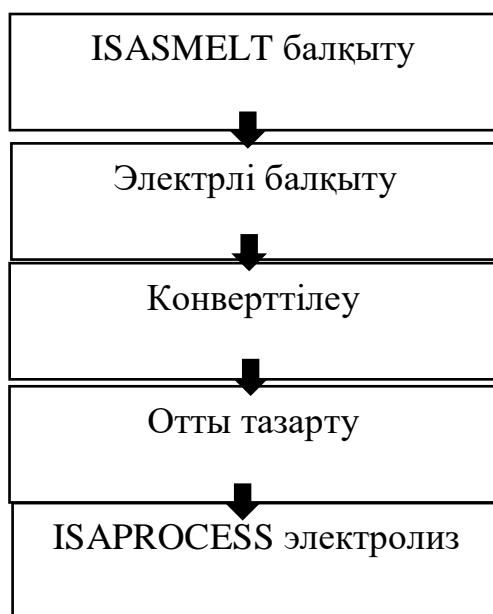
Сурет 1 «Қазмырыш» түсті металлургия кәсіпорынында мысты алудың технологиялық сызбасы
