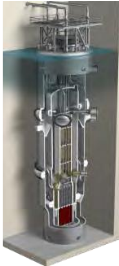
Рисунок 1. Дизайн конструкции NuScale Power Module™ (NPM). [4]
