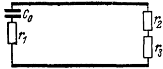
Рис. 6-10. Схема линии с потерями.
