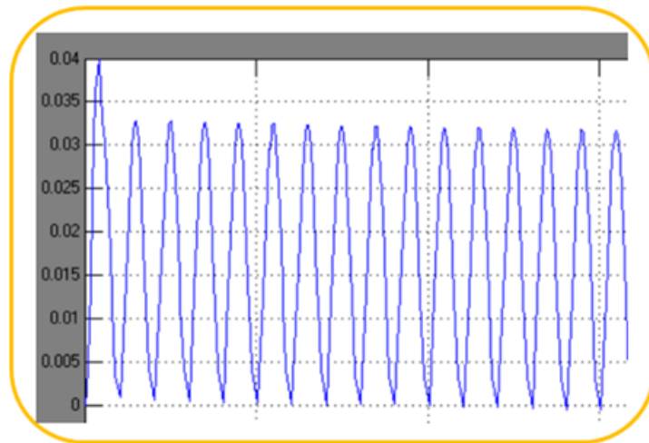
Сурет 6 – Төмен жиілікті электромагниттік қоздырғыштың кернеуіне тән уақыт сипаттамасы
