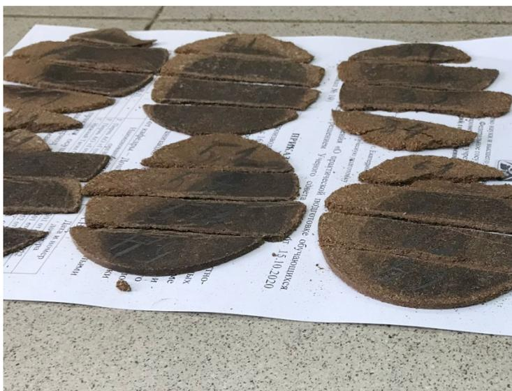
Рисунок 2 – Готовые диски для определения биологического разложения
