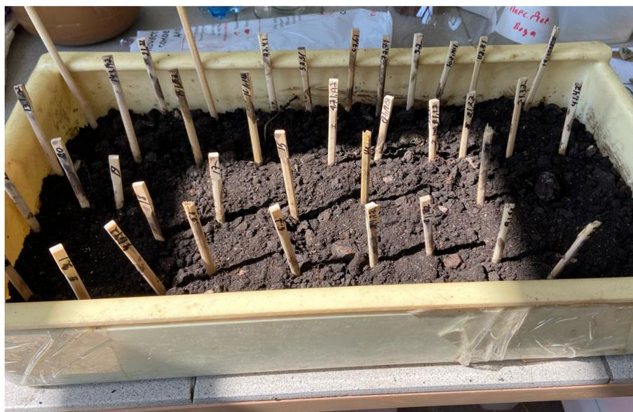
Рисунок 3 - Закопанные образцы в грунте на биоразложение
