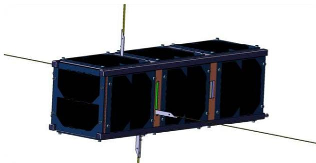
Рисунок 2 – Приблизительный вид 3D-модели студенческого наноспутника
