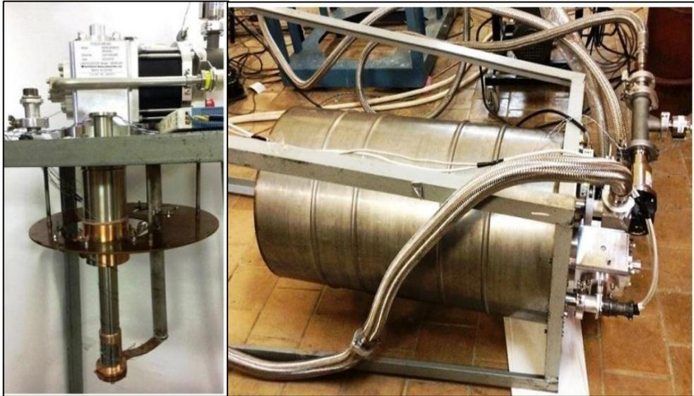
Рисунок 2- Шахтный криостат с криокулером RDK-408D2 в горизонтальном положении.
