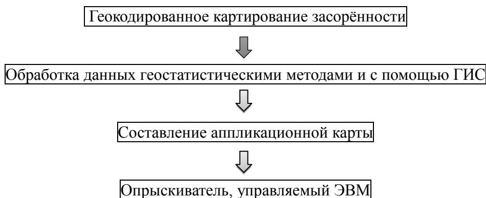
Рисунок 1 – Основные шаги при дифференцированном внесении гербицидов в двухэтапном технологическом процессе
