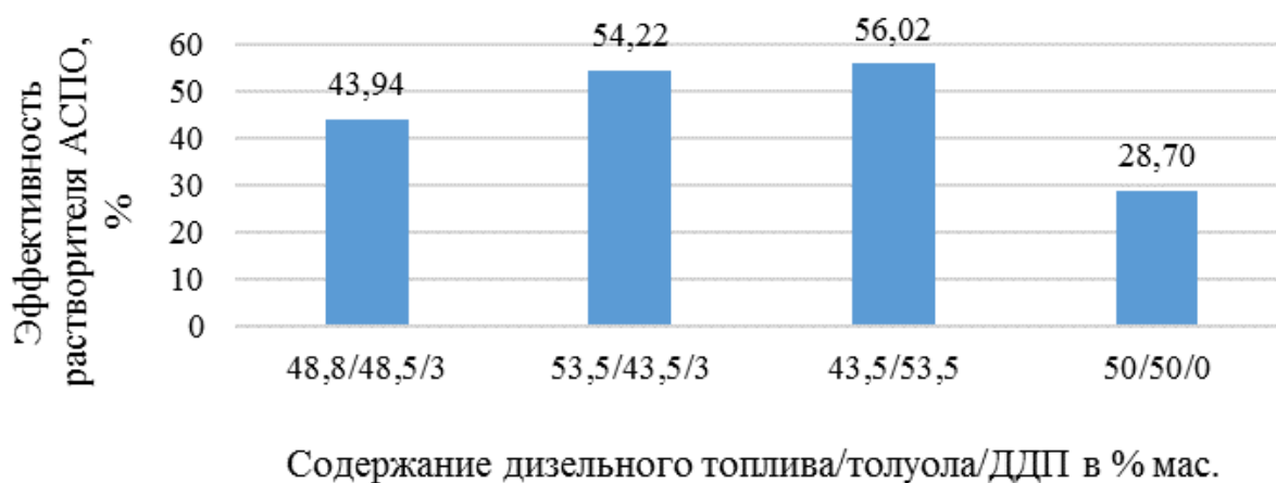
Рисунок 2 – Моющая способность растворителя АСПО при различных концентрациях его компонентов (дизельного топлива, толуола и ДДП)
