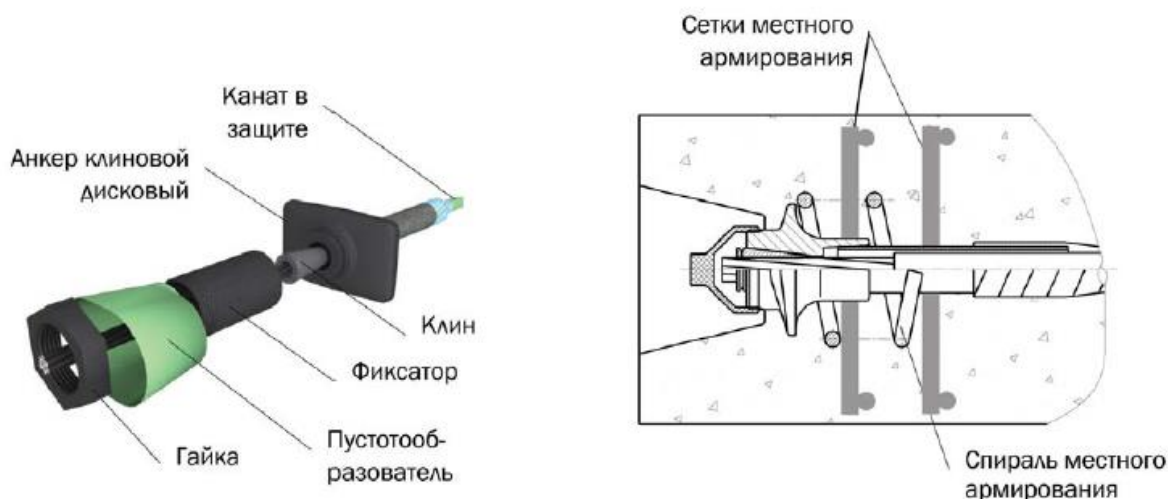
Рис. 4. Элементы монтажа анкера АКД-1 в опалубке [5]
