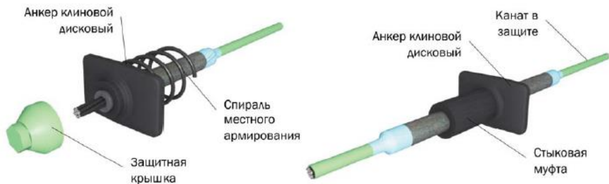
Рис. 5. Пассивный узел с анкером АКД-1 и стык СКД-1 [5]
