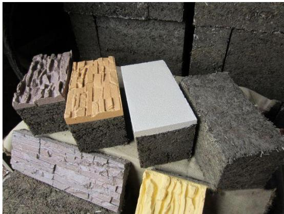
Рис.4 Внешнее декорирование арболита
