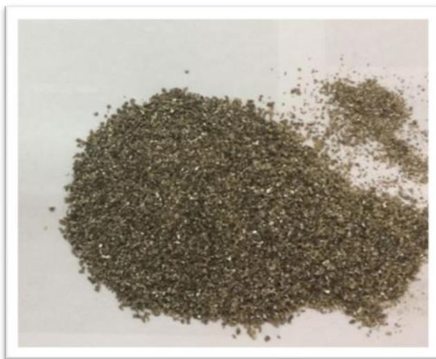
Рис. 1. Вспученный в микроволновой печи вермикулит
