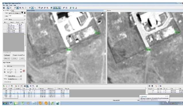
Рисунок 3 - определение опорных точек на снимке
