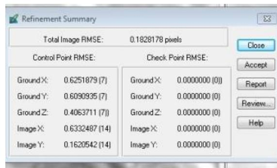
Рисунок 5 - Конечный результат уравнивания математической модели/блока
