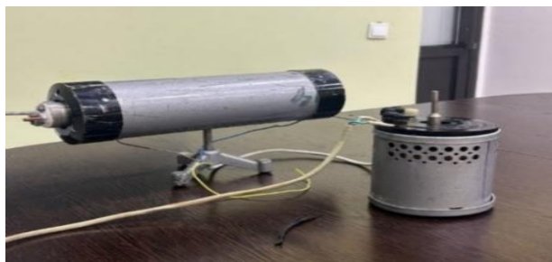
Сурет 3 Вакуумдық қондырғыда никель қабыршағын күйдіру және никель оксидін қалыптастыруға арналған дөңгелек пеш
