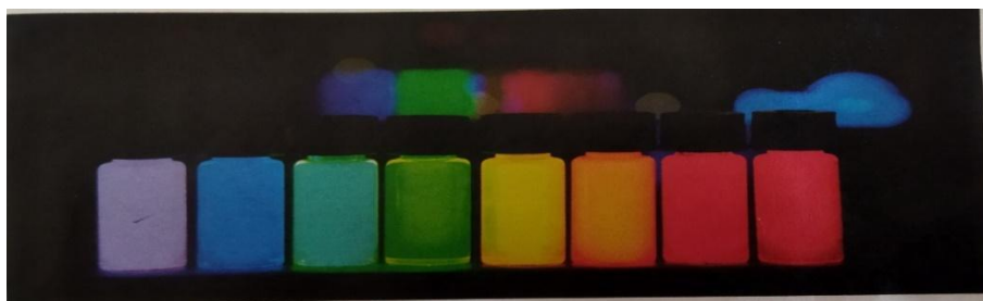
Рисунок 1 – Яркое свечение в диапазоне от фиолетового до красного, которые дают квантовые точки
