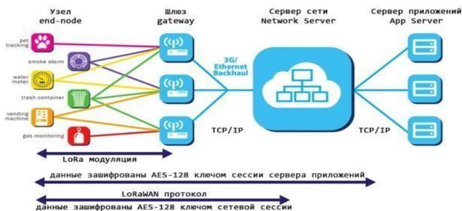
Сурет 2 – LoRaWAN желісінің архитектуралық сызбасы
