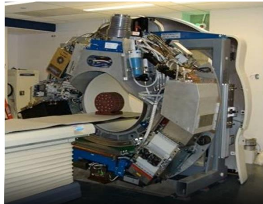
1-сурет - Томотерапия қондырғысының ішкі және сыртқы көрінісі.
