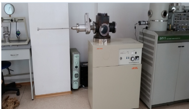
Рисунок 5 – Вакуумный универсальный пост и шлюзовая камера
