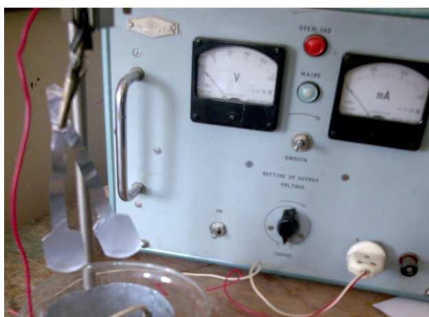
Рисунок 1 – Электролитическая ячейка, предназначенная для нанесения слоя Al_2O_3
