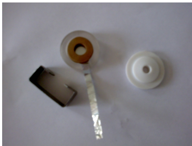
Рисунок 2 – Форма, предназначенная для удаления слоя Al_2O_3 плавиковой кислотой с одной стороны образца
