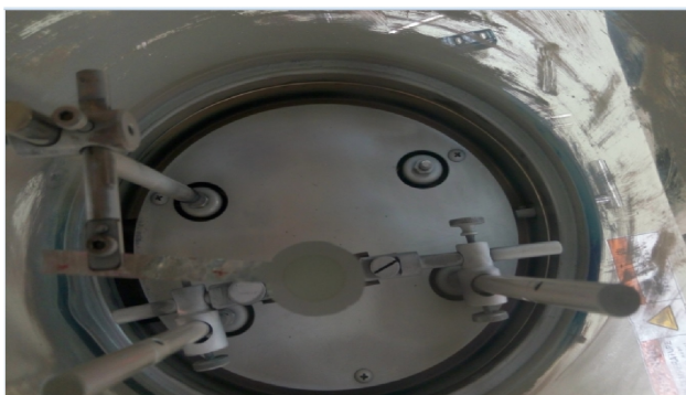
Рисунок 4 – Напыление лития на подложку с мишенью
