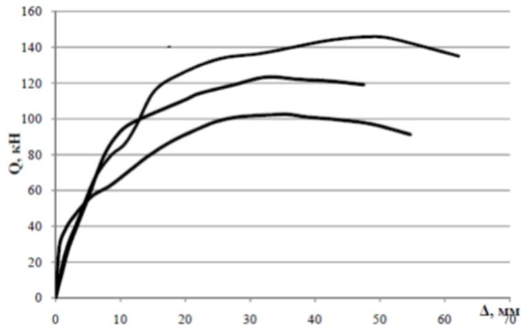
Рис.7 Диаграмма деформирования сварного соединения [4]
