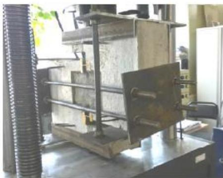
Рис.5 Натурный образец сварного вертикального соединения [4]
