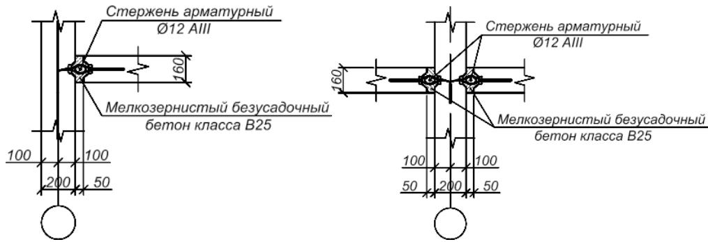
Рис. 3 Вертикальный стык панелей с петлевым соединением
