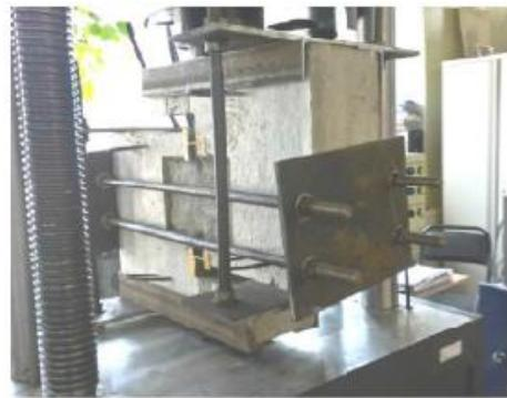
Рис.5 Натурный образец сварного вертикального соединения [4]
