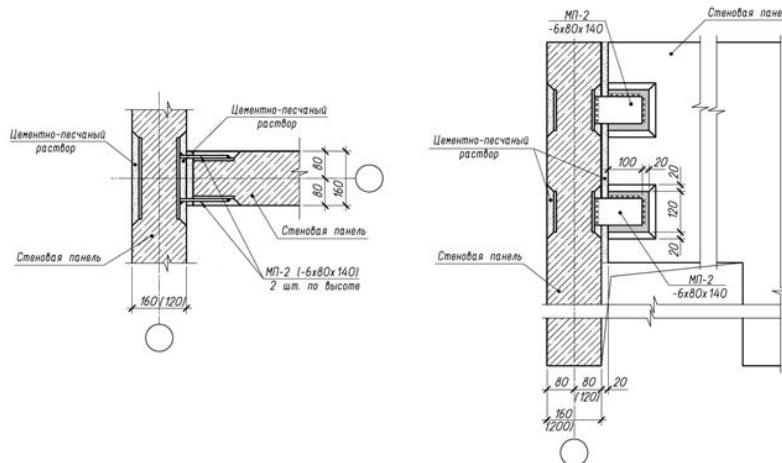
Рис. 1 Вертикальный стык стеновых панелей
