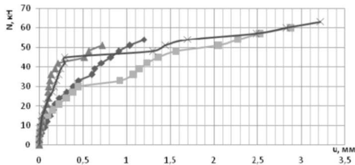
Рис.6 Диаграмма деформирования петлевого соединения [3]
