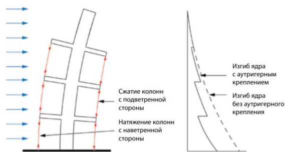
Сурет 4. Ядро мен аутригерлердің өзара әрекеттесуі
