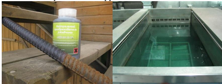
Рис.5 - Очистка арматуры методом химического воздействия
