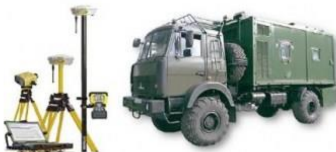
Рисунок 1. Подвижный навигационно-геодезический комплекс смонтирован на шасси автомобиля КАМАЗ 4350.
