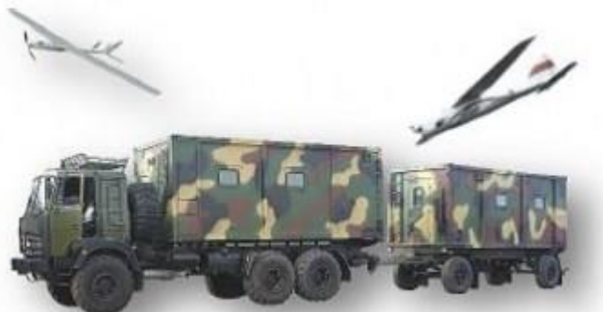
Рис. 2 . Подвижный навигационно-топографический комплекс смонтирован на шасси автомобиля КАМАЗ 4350 с кузовом-фургоном К4350Д
