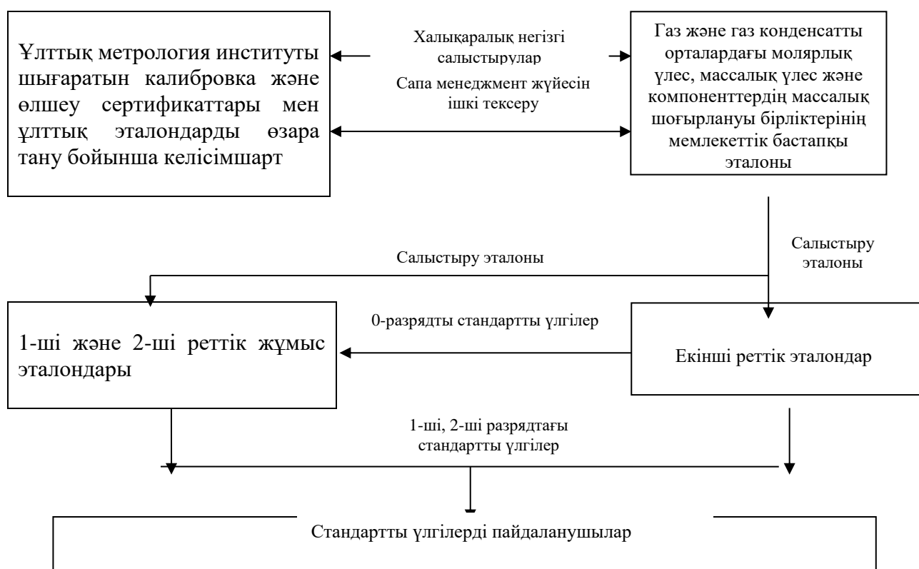
Сурет-1 ГОСТ 8.578-2014 бойынша қысым баллондарындағы газ қоспалары құрамының стандартты үлгілерін метрологиялық бақылау
