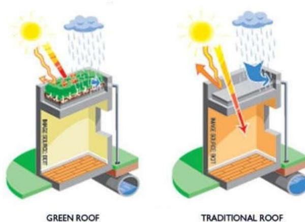
Рисунок 1 Сравнение традиционной и «зеленой» кровли
