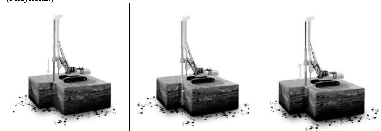
Рисунок 2. Операции технологии глубинного перемешивания грунта [7].
