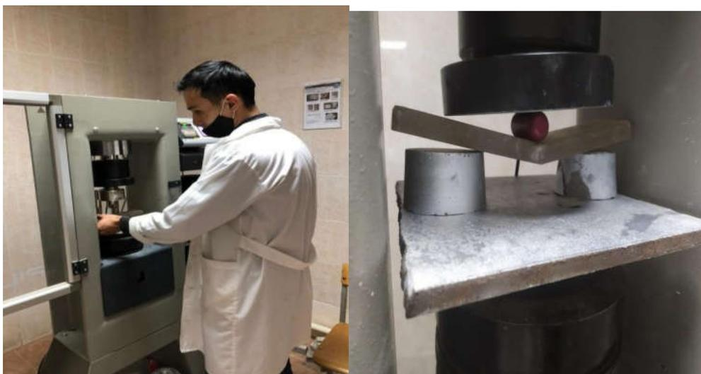
Рисунок 6 – Испытание полимерного образца на гидравлическом прессе
