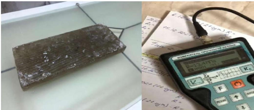
Рисунок 4– Фотографии полученного полимерного материала и прибора для измерения прочности материалов
