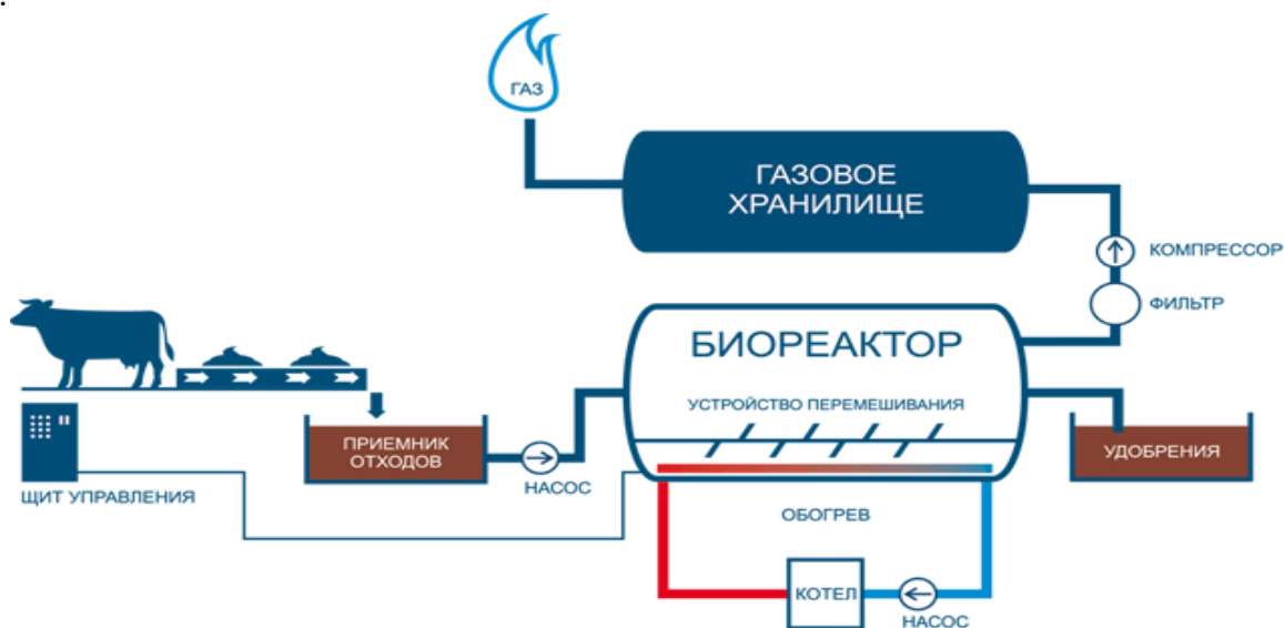
1 сурет - Қарапайым биогаз қондырғысының схемасы
