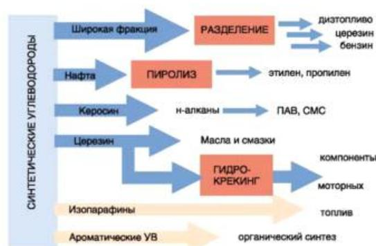
Рисунок 1 - Направления переработки синтетических углеводородов
