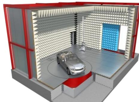
Поглотители в БЭК изготовлены из пенополиуретана, а плиты состоят из усеченных пирамид. Безэховая камера РГП «КазСтандарт» строилась под конкретное помещение, где все продумано до мелочей: необходимый уровень экранирования, правильно подобранные поглотители, спроектированная система вентиляции и подачи электропитания. Оснащение камеры предусматривает управляемый поворотный стол, антенную мачту для управления антеннами, пандус для перемещения тестовых образцов, удобные экранированные двери и т.д.
