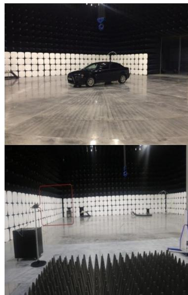
тестировании крупных по размеру образцов техники (автобусы, военная и сельхоз.техника и др.) и оборудовано специальными радиочастотными поглотителями.
