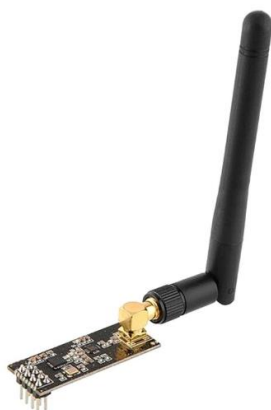
Сурет 2 - 2,4 ГГц жиіліктегіші мен қабылдағышы бар nRF24L01 + чипі
