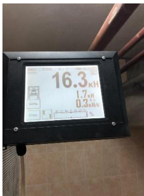
Сурет 1.5. Пресс ИП-1А-1000. Үлгінің 14 тәуліктегі нәтижесі
