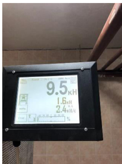
Сурет 1.4. Пресс ИП-1А-1000. Үлгінің 7 тәуліктегі нәтижесі
