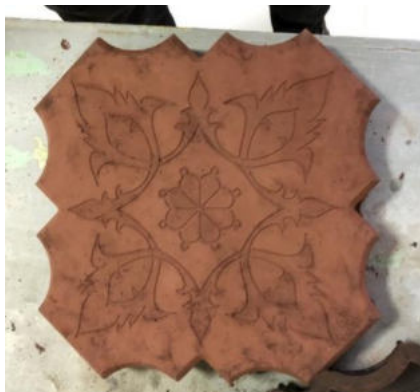
Сурет 1.2. Жаяужол тақтасының зертханалық ПРЕССке жіберу алдындағы үлгісі
