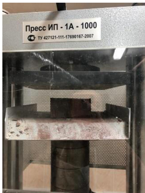
Сурет 1.4. Пресс ИП-1А-1000. Үлгінің 7 тәуліктегі нәтижесі
