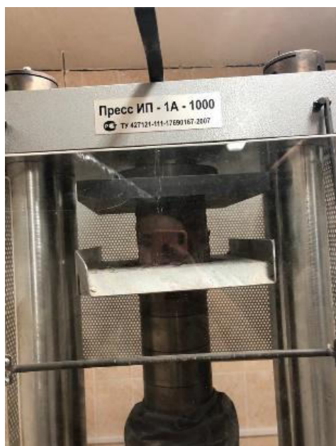
Сурет 1.5. Пресс ИП-1А-1000. Үлгінің 14 тәуліктегі нәтижесі
